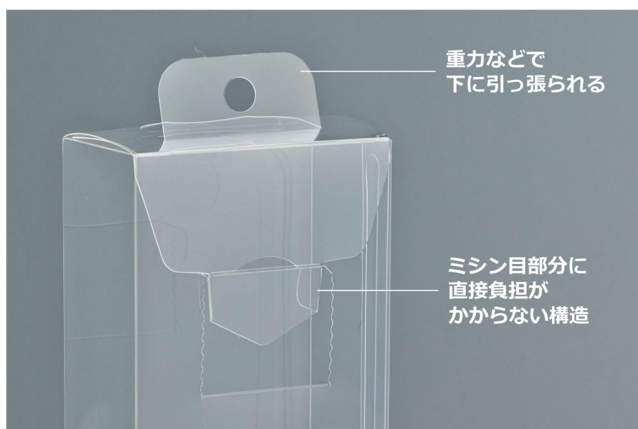
画像②: 上蓋のヘッダーで吊り下げ陳列をしてもミシン目は垂直方向の力には対しては破れにくいいためミシン目部分に直接負担がかからない構造
